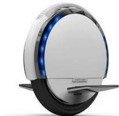
Моноколесо - современный электрический самобалансирующийся самокат с одним колесом и расположенными по обе стороны от колеса подножками. Самокат использует различные датчики, гироскопы и акселерометры, вместе с электродвигателем для автоматической балансировки. Завоевывает популярность у взрослых и детей, когда стоя на одном колесе в пластиковом корпусе достаточно только наклониться, чтобы поехать вперед или остановиться.
